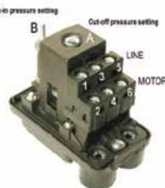
El MacPress es la gama de presostato de MAC3. El dispositivo viene calibrado de fábrica con una presión de ajuste que se puede cambiar a través del sistema de control interno. La instalación del MacPress se realiza directamente en el tubería mediante una conexión hembra de 1/4". Está disponible para bombas tanto monofásicas como trifásicas en las dos versiones de alta y baja presión.
