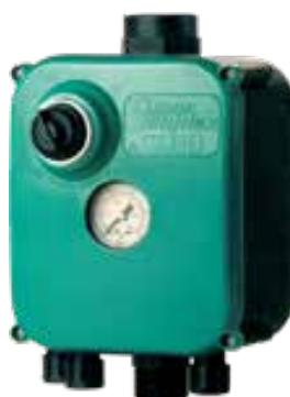
SuperSimplex M, versión electrónica con entrada para un flotador de mínima. Permite ajustar la presión de arranque entre 0,8 a 2 bares a través de un mando. Con la apertura de una válvula/grifo, la presión cae por debajo del umbral de reinicio y el SuperSimplex activa la bomba. Cuando el usuario cierra el flujo de agua el SuperSimplex detiene la bomba después de un retardo adecuado.
