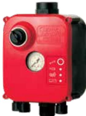
SuperSimplex E es un presostato muy versátil que le permite ajustar la presión de arranque entre 0,8 a 2 bares a través de un mando frontal y un manómetro de presión en el dispositivo. Desde fábrica se suministra ajustado a 1,5 bar. SuperSimplex E, versión electrónica con la protección de funcionamiento en seco y reinicio automático.
